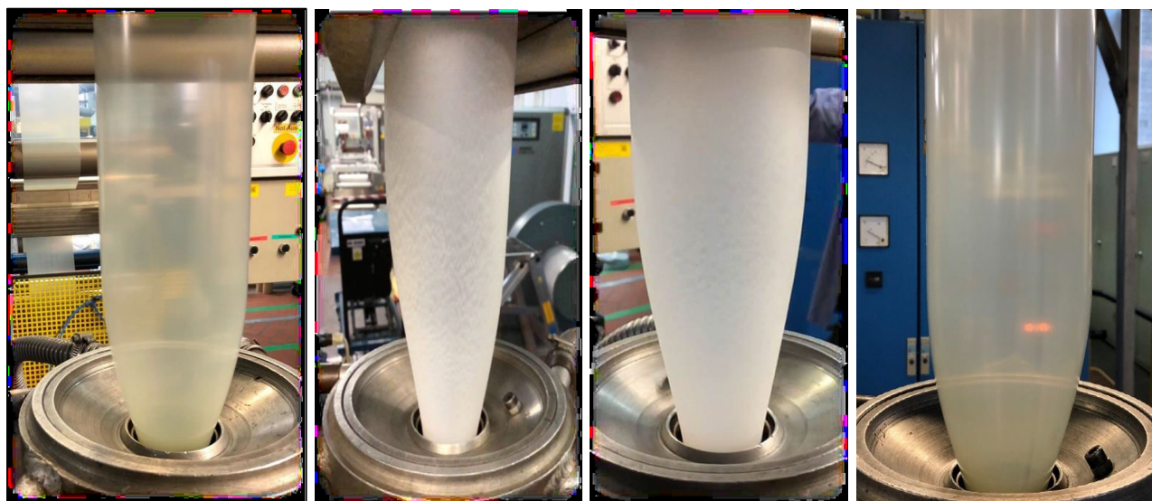
Fig. 29a–d: Óptica de la burbuja de monopelícula (temperatura de fusión): a) 5 % PA6 (
