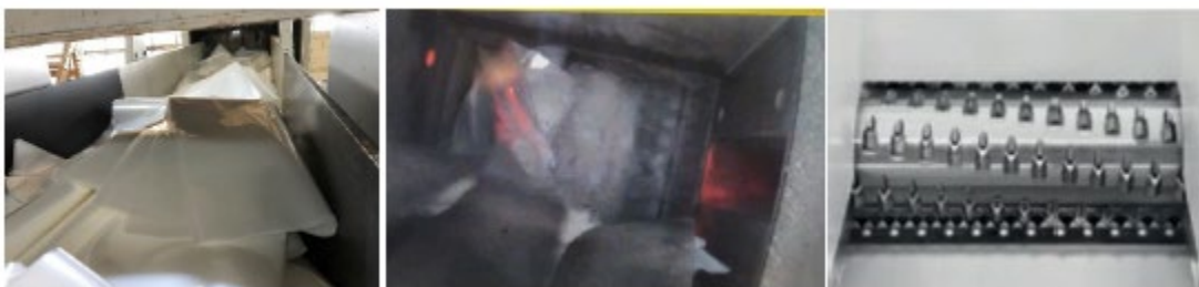
Fig. 25: Impresiones de S Gran 95 (des la izquierda: Suministro de material, unidad de corte, husillo)
